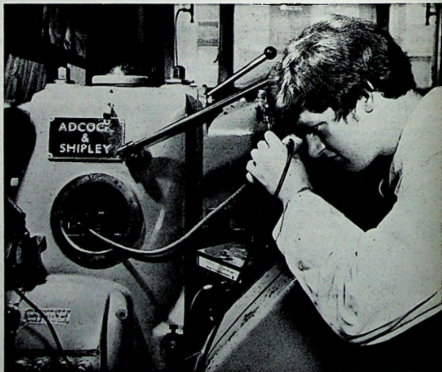
Afb. 8. Flexibele slang om op ontoegankelijke plaatsen een blik te kunnen werpen: de fibroscopie, een flexibele lichtgeleider; zie -R-E- 9-68 Taylor Hobson.
